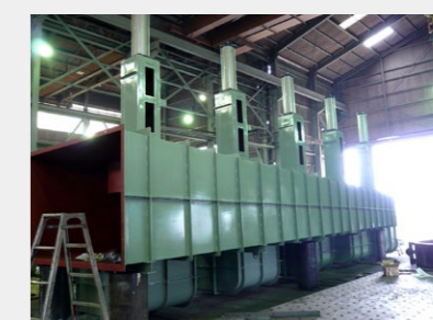
■コークス集塵機入口ダクト
