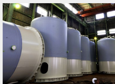
■ 圧力式二層ろ過器
