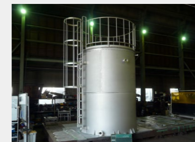
■ 苛性ソーダ貯留タンク
