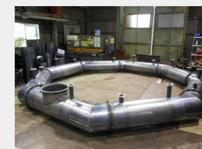
■2次燃焼ヘッダーダクト
