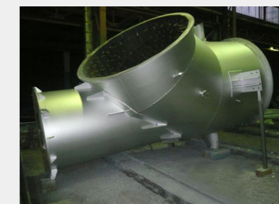
■炉頂排ガスダクト
